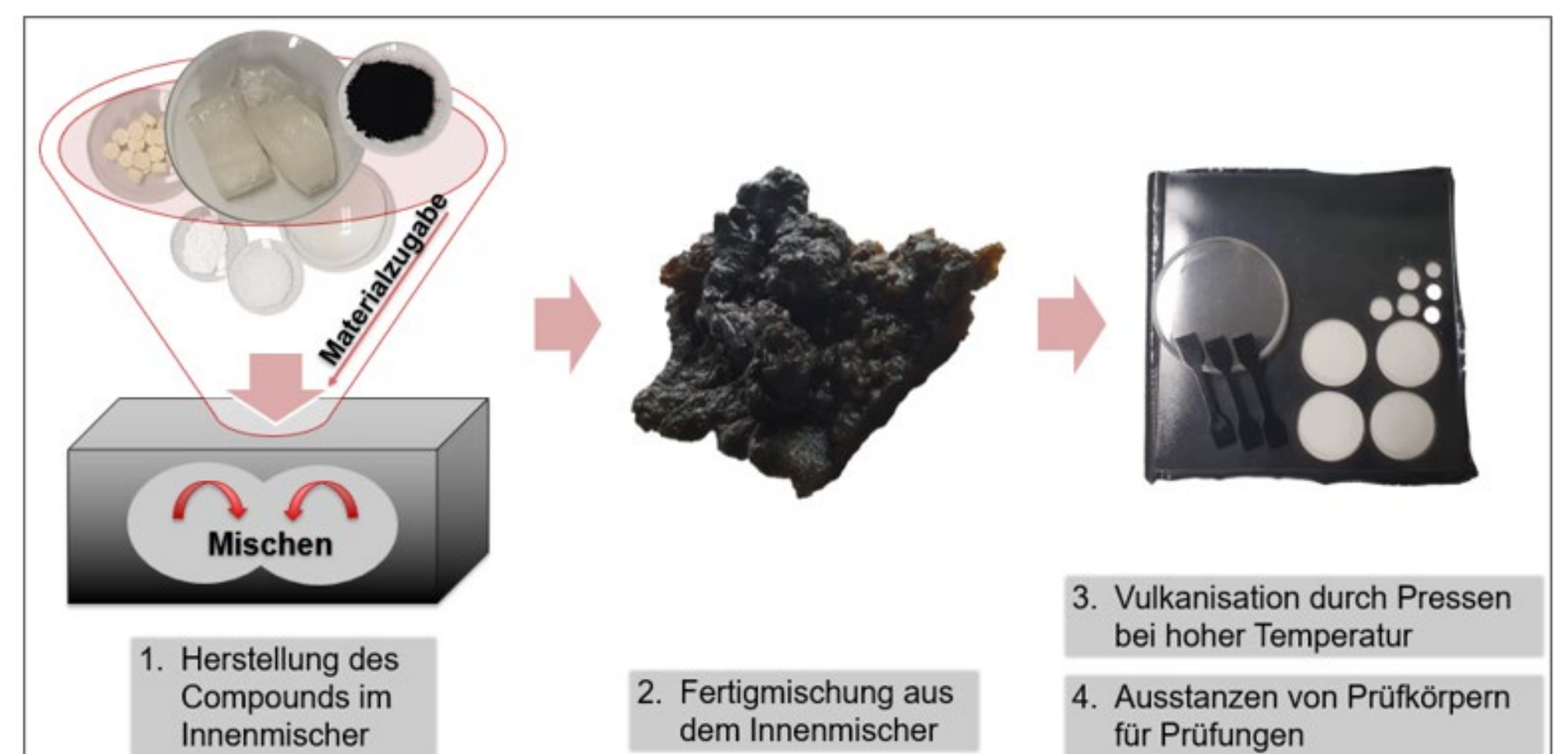
Abbildung 3: Herstellung neuer Compounds mit veredeltem rCB
